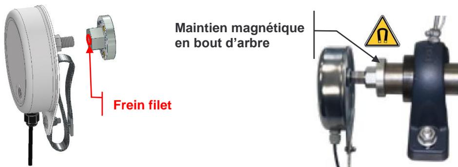
Terminer par fixer la sangle anti-rotation sans créer de tension entre le VIGIRO® IP26 le point d'ancrage.
