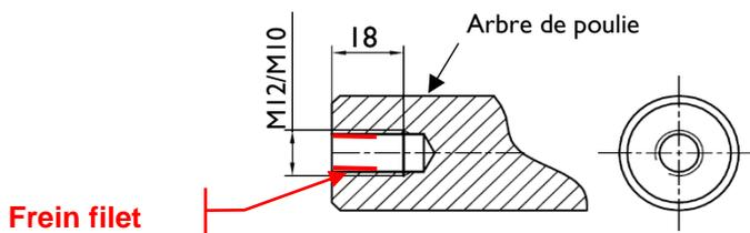
Enduire de frein filet démontable le taraudage, puis visser le VIGIRO® IP26 sur l'arbre de poulie avec une clé plate de 16mm. Veillez à respecter le temps de prise du frein filet avant la première mise en service.
